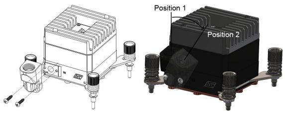
Por defecto, los puertos de entrada y de salida están instalados verticalmente. Es posible orientarlos con otro ángulo con el fin de facilitar su "enrutamiento". Para cambiar la orientación, desmontar los 2 tornillos que ajustan el puerto al bloque, realinearlos en la segunda posición de montaje, luego atornillarlos correctamente.
