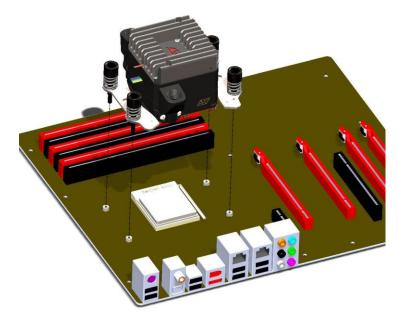
Deposite el Apogee™ Drive II sobre el CPU y alinee los tornillos muelle a los respectivos horificios de la placa base. Luego ajuste los tornillos progresiva y alternativamente, en cruz, hasta el tope.
