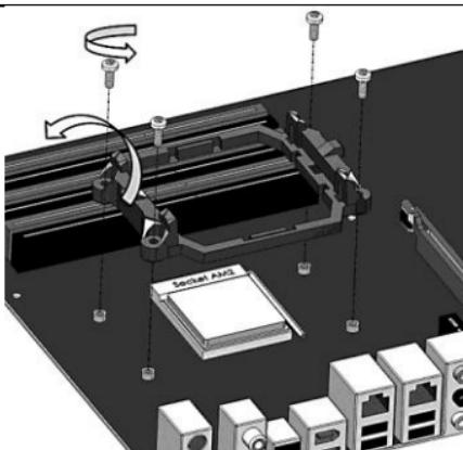
卸下主板上备用的散热片塑料扣具。
