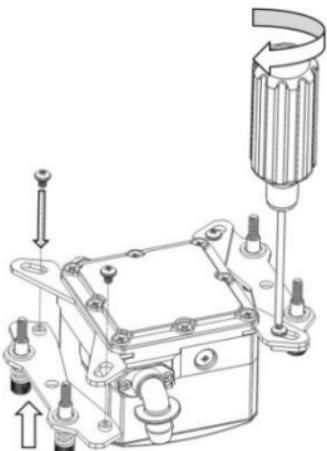
Socket AM2/AM3 – FM1/FM2: スプリング付きネジとブラケットの組み立て済み AMD 用アセンブリを、CPU クーラー側に付いているブラケットに固定します。
