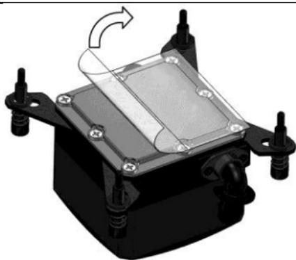
Retire a folha de protecção de plástico da base do bloco de arrefecimento em cobre.
