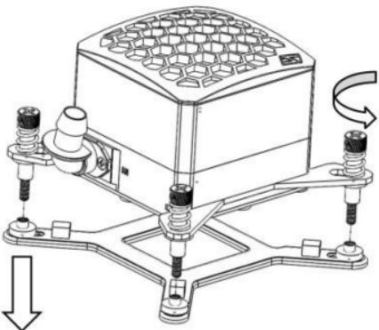
Для защиты от повреждения при транспортировке, процессорный кулер поставляется с универсальным материнскую плату пластины предварительно установлена. Она должна быть удалена в первую очередь.
