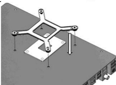
Fijar la placa trasera a la parte posterior de la placa base, asegurando que las bandas pasan a través de los orificios de montaje. La placa base está listo para la instalación del bloque de refrigeración.
