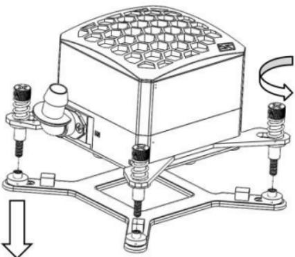
Per evitare danni durante la spedizione, la ventola per il processore è spedita con il back-plate già preinstallato, è necessario rimuoverlo prima di effettuare l'installazione.
