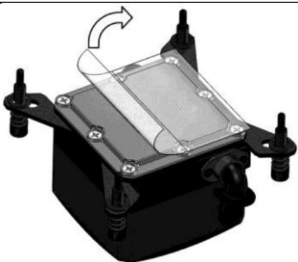
撕掉 CPU 水冷头上的保护膜。
