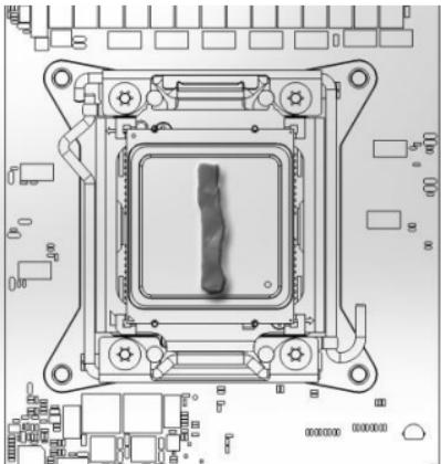
Limpie el CPU con un desengrasante (preferiblemente diseñado especialmente para los componentes electrónicos), y luego aplicar la pasta térmica TIM-MATE 2 provista, como se indica
