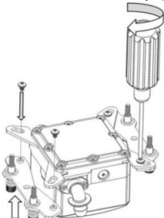
将已经预装好的 AMD 主板专用的弹簧螺丝和支架安装在 CPU 冷头现有的托架上。
