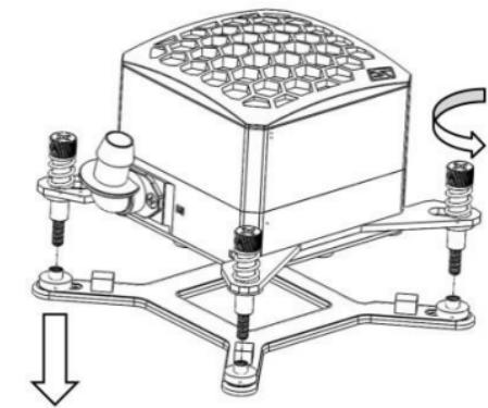
運送途上の損傷を防ぐため、ユニバーサルマザーボードバックプレートを取り付けた状態で CPU クーラーを出荷しています。最初に、バックプレートを取り外します。
