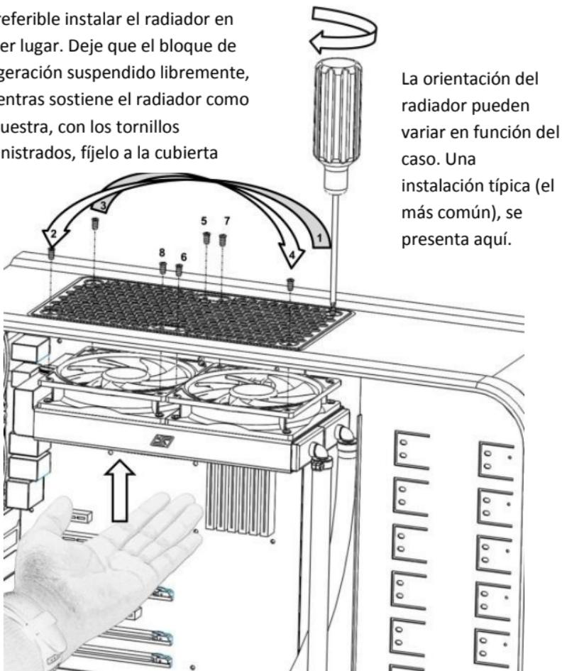
La orientación del radiador pueden variar en función del caso. Una instalación típica (el más común), se presenta aquí.
