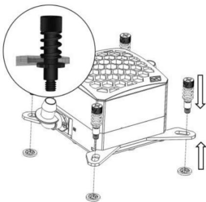
Installare le viti a molla per le cpu Intel® con socket LGA 2011
