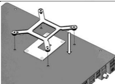
Afixar a placa traseira a parte de trás da placa mãe, assegurando que os espaçadores passam através os orifícios de montagem.. A sua placa mãe está disposta para a instalação do bloco de arrefecimento.
