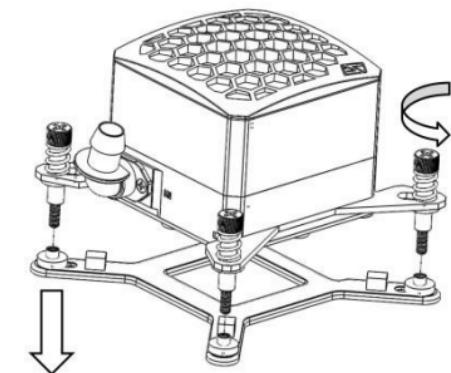
Para protegerlo contra daños durante su transporte, la bloque de refrigeración viene con placa universal, preinstalada que prealablemente debe ser retirada.
