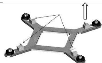
当六角螺柱已经调整到需要的位置，撕掉各个海绵垫上的保护膜
