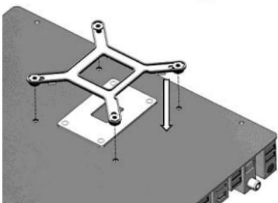
Befestigen Sie die Backplate an der Rückseite Ihres Mainboards und stellen Sie dabei sicher, dass die Abstandshalter korrekt in die Mainboard-Löcher eingepasst sind. Ihr Mainboard ist nun für die Aufnahme des CPU-Kühlers vorbereitet.
