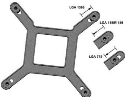
将背板上四个角的六角螺柱根据主板平台的型号，移动到合适的位置
