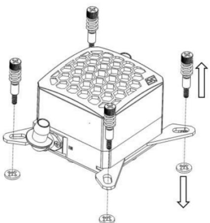
Default a unidade de refrigeração está pré-configurada com parafusos de montagem para Intel®LGA 1366/1155/1156/775.
