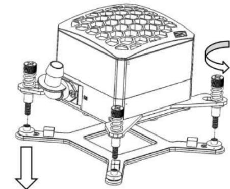
Aux fins de protection contre les avaries de transport, le bloc de refroidissement est livré avec la plaque arrière universelle préinstallée. Celle-ci doit être préalablement démontée.
