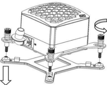
Um zu verhindern, dass der CPU-Kühler während des Transports beschädigt wird, ist die universelle Backplate vorinstalliert. Diese muss entfernt werden, bevor Sie fortfahren.
