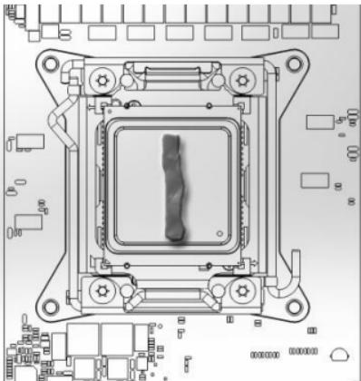
Nettoyer le CPU avec un dégraissant (de préférence spécialement conçu pour les composants électroniques), puis appliquer la pâte thermique TIM-MATE 2 fournie comme indiqué ci-joint.
