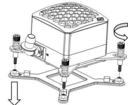
Para a proteção contra danos durante o transporte, o bloco de resfriamento vem com backplate universal pré-instalado. Ele deve ser removido antes.
