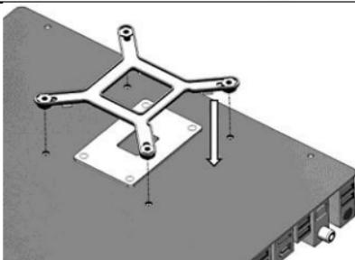
バックプレートをお使いのマザーボードの背面に合わせます。このとき、マザーボードの穴に支柱が正しく収まっていることを確認してください。これでマザーボードに CPU クーラーを取り付ける準備が整いました。
