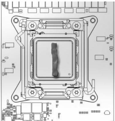
Очистите процессор с обезжиривателем (желательно сформулировать для электроники), то применяют поставляемые TIM-MATE 2 термопасту на процессор, как показано на рисунке.
