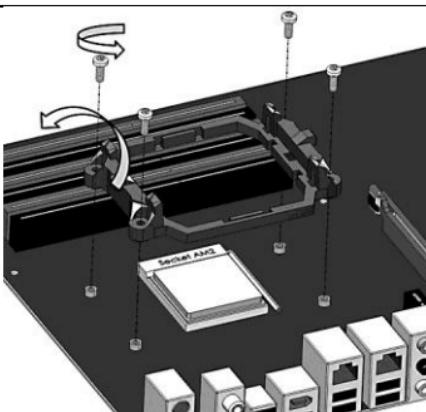
Desmontar la pieza original de plástico de la placa base como se muestra.
