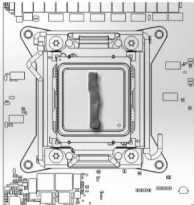
油脂落とし(電子部品用に用意されているものが望ましい)を使って CPU を清掃し、付属の TIM-MATE 2 サーマルコンパウンドを図のように塗布します。
