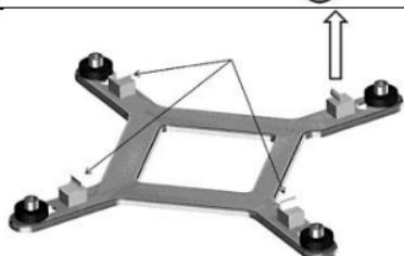
Sobald die Abstandshalter in die gewünschte Position gebracht wurden, entfernen Sie die Schutzfolie von den selbstklebenden Schaumstoff-Pads.
