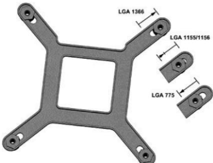
可動式のネジ支柱をいずれも次の位置に移動します。
