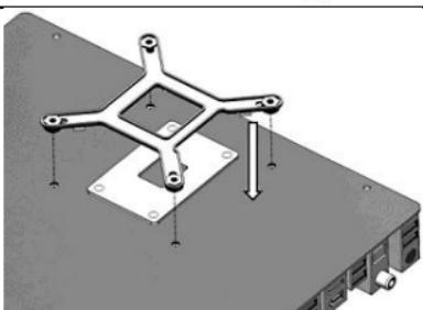
Fate combaciare il backplate con la parte posteriore della scheda madre, assicuratevi che il backplate si fissi correttamente con i buchi della scheda madre e permetta un fissaggio corretto della ventola tramite le viti in dotazione.
