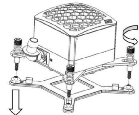
为了防止水冷头在运输过程中受损，已经预先将通用的背板安装在水冷头上，使用前需先卸下这个背板。
