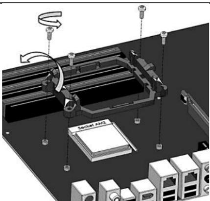
標準ヒートシンクのプラスチック製リテンションフレームを取り外します。
