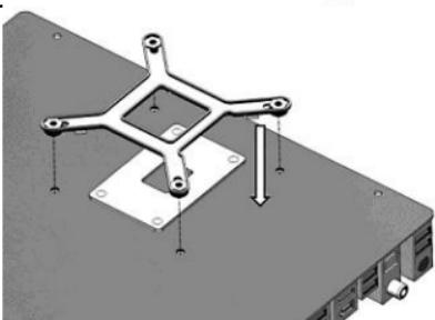
将背板对准主板的背面，确保螺柱已经正确地插入了主板的安装孔里。
