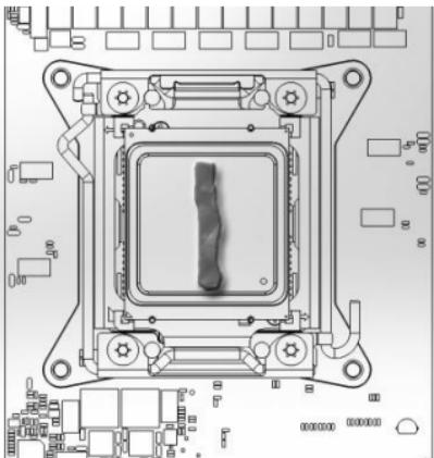
Limpe o CPU com um desengraxante (De preferência especialmente concebido para componentes eletrônicos) em seguida, aplicar a pasta térmica TIM-MATE 2 fornecido como mostrado aqui.
