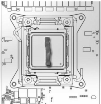
用脱脂剂清洁 CPU 表面（最好是使用电子元器件专用的脱脂剂），然后将随产品提供的 TIM-MATE 2 型导热膏按左图的方式涂在处理器上。
