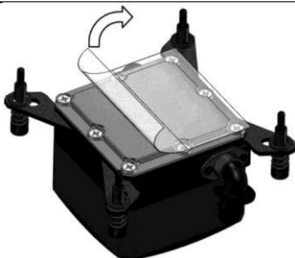
Rimuovete il film protettivo dal dissipatore della CPU.
