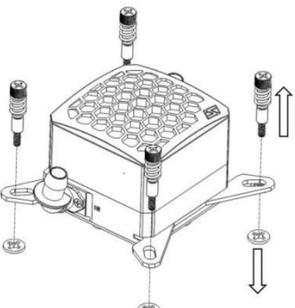
Standardmäßig ist der CPU-Kühler mit Federschrauben für die Montage auf Intel® LGA 775/1156/1155/1366 ausgerüstet.
