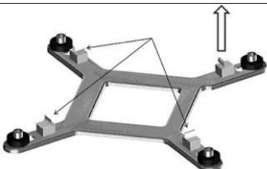
После распорки были настроены в желаемое положение, пожалуйста, отрывной защитную бумагу с каждой из 4 пластиюро пены.
