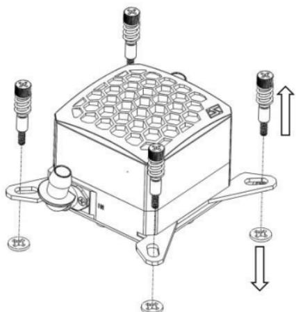
Di default, il dissipatore della CPU è spedita preconfigurata per Socket Intel® LGA 1366/1155/1156/775.
