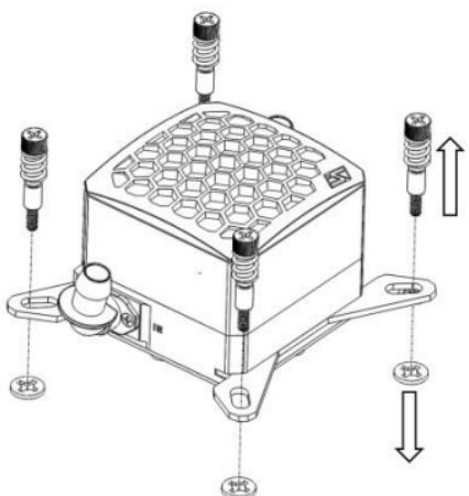
Par défaut, le bloc de refroidissement est préconfiguré avec les vis de montage pour Intel® LGA 1366/1155/1156/775.
