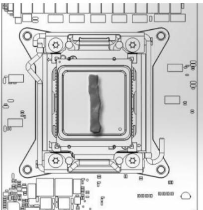
Reinigen Sie die CPU mit einem Entfetter (vorzugsweise für Elektronik entwickelt), danach tragen Sie die mitgelieferte TIM-MATE 2 Wärmeleitpaste auf dem Prozessor auf, wie auf dem Bild zu sehen.
