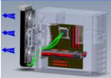
Refroidissement liquide du CPU seul
