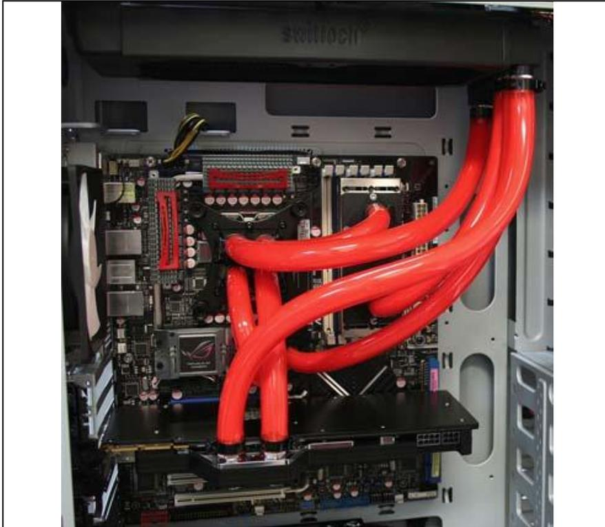
Exemple de configuration en série + parallèle en utilisant le bloc Apogee™ HD et le radiateur MCR 320 Drive: les blocs GPU, Chipset et mémoire sont connectés aux trois ports de sortie de l'Apogee™ HD, et chaque ligne de sortie de ces blocs est ensuite connectée à l'un des ports d'entrée du MCR Drive.
