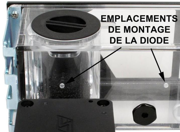
Déposez une petite goutte de colle de type cyanoacrylate (Loctite, Superglue, Krazy glue - non fournie) sur le corps de la diode, puis insérez celle-ci immédiatement à l'emplacement de votre choix. Avant de coller la diode, nous vous recommandons d'essayer d'abord avec le liquide de refroidissement remplis afin d'examiner l'emplacement qui vous convient le mieux.
