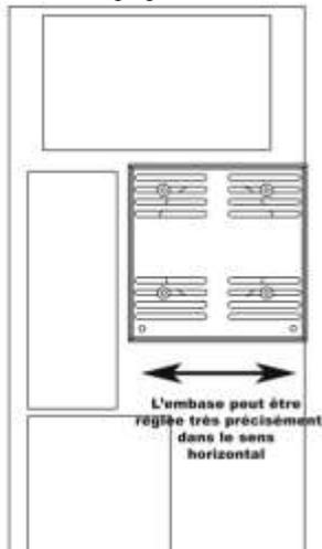
L'embase peut être réglée dans le sens vertical par intervalles de 8mm
