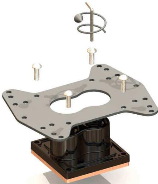
Etappe 1: Sie schrauben die 4 Schrauben mit dem Inbusschlüssel (mit dem Water block expediert) los, und Sie bauen die Befestigung Platte aus.
