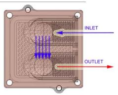
Gardez l'orientation des pins avec l'orientation de l'entrée et de la sortie du couvercle du water-block afin de laisser un chemin clair et direct au fluide et qu'il puisse passer entre l'entrée et la sortie.
