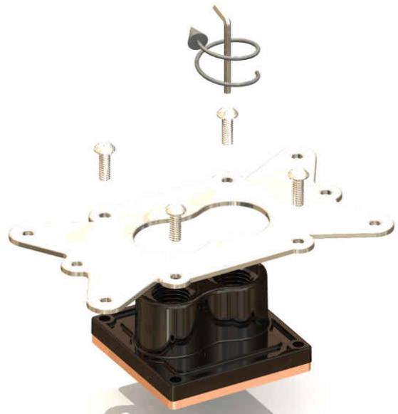
Etappe 2: Sie positionieren die AM2 Befestigungsplatte und Sie befestigen die 4 Schrauben: **Achtung immer Schrittweise & schrägläufend!**
