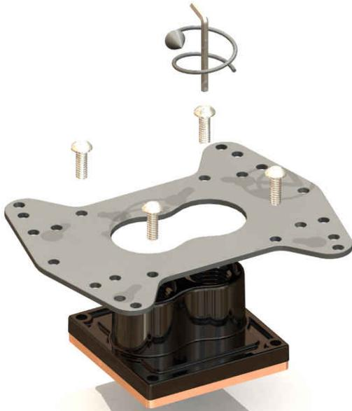
Etappe 1: Sie schrauben die 4 Schrauben mit dem Allen Schlüssel (mit dem Water block expédiert) los, und Sie bauen die Befestigung Platte aus.
