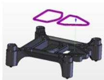
5. Sie bauen die beide O rings von der 775 Befestigungplatte...
