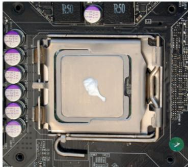
1. Déposez une petite quantité de graisse thermique Arctic Céramique™ sur le microprocesseur.
