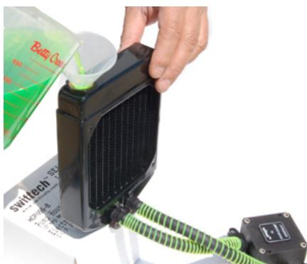
Con relación al Apogee Drive, coloque el radiador a la misma altura y llene hasta el borde. ¡Atención no debe desbordarse!
