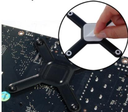
Sie schälen das Schutzpaper auf die Befestigungsplatte und Sie installieren sie an der Rückseite des Motherboards. Dann installieren Sie wieder das Motherboard im Chassis (Sie folgen den Anleitungen von dem Hersteller).
