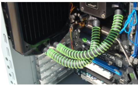
Sie benutzen dieselbe Technik, um das zweite Schlauch zu installieren.
