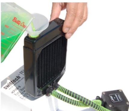
Sie starten das Netzteil (der Apogee™ Drive wird 3 Sekunden später starten). Als Die Pumpe startet, hören Sie den Lärm von der Kühlflüssigkeit und der Luft, die sehr schnell in der Pumpe zirkulieren. Einige Sekunden später, ist das Lärm leiser. Das bedeutet, dass alles in Ordnung ist!
