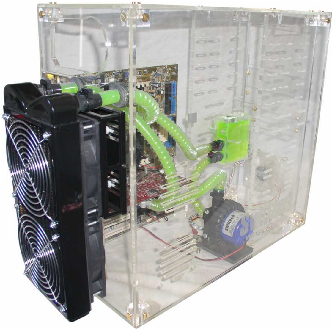
Exemple d'installation, incluant un water-block MCW55 pour carte graphique.
