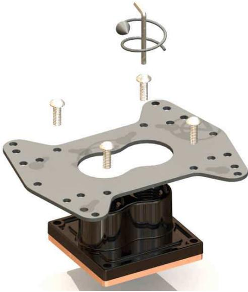
Etappe 1: Sie schrauben die 4 Schrauben mit dem Allen Schlüssel (mit dem Water block expediert) los, und Sie bauen die Befestigung Platte aus.
