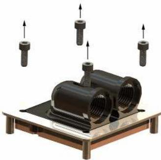
Schrauben Sie die 4 Schrauben mit dem Allen Schlüssel ab und bauen Sie die Befestigungsplatte aus, denn Sie sie nicht brauchen.
