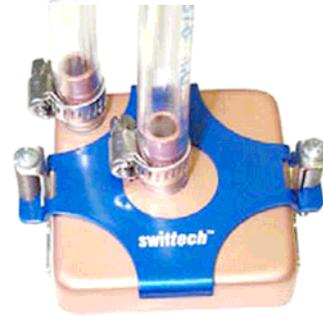
Tuyaux attachés avec les serre-tubes fournis
