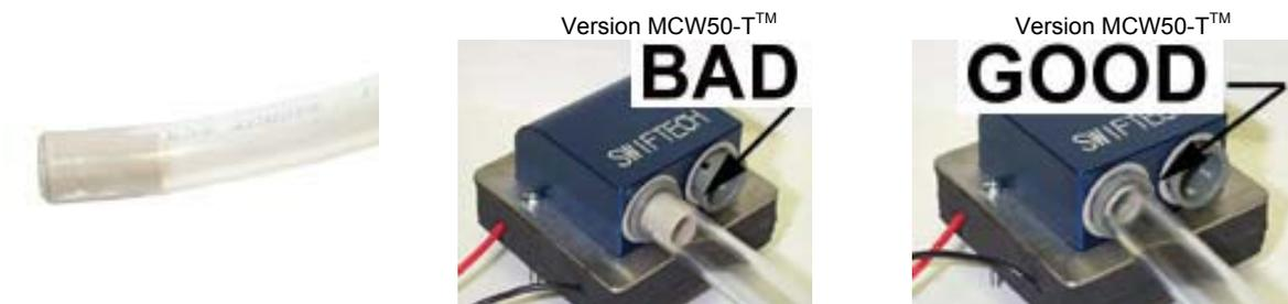
Assurez-vous que les tuyaux soient bien insérés dans les raccords. L'extrémité de l'embout en plastique doit être au même niveau que l'ouverture d'entrée/sortie, comme dans l'image au dessus à droite. Pour bien faire entrer les tuyaux, il faut pousser fermement avec un mouvement de rotation. Afin de faciliter la pénétration vous pouvez lubrifier le bout des tuyaux avec une goutte de savon liquide.
