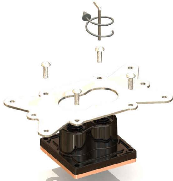
Etape 2: Placez la plaque AM2 sur le corps du water block et vissez les 4 vis
