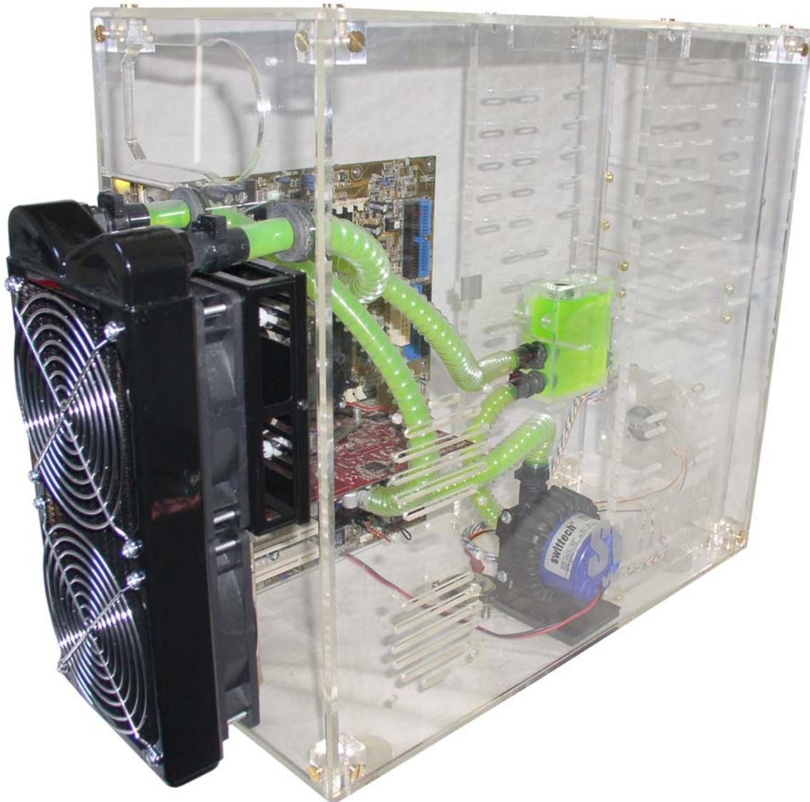
**Beispiel von einer Installation (mit dem MCW55 WATERBLOCK VGA)**
