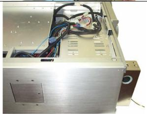
**Etappe Nu 6.** Stellen das PC vertikal zurück, aber schalten sie immer Schräg von 15 bis 20° und füllen Sie die Höhe des Reservoirs immer langsam, um es nicht zu überlaufen. Schließlich, festdrehen den Reservoir mit den gelieferten Schrauben in den CDROM Schacht.
