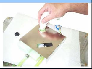
**Etappe Nu 5.** Liegen dem Reservoir auf den PC an, und füllen die Höhe. Schließen den Deckel des Füllens nicht zu stark, denn er hat einen O-Ring, um wasserdicht zu sein.
