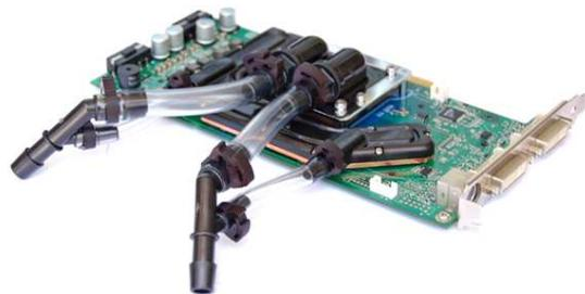
**Étape 3:** Installez les tuyaux sur les 2 raccords "F" comme illustré sur la photo. Le raccord du bas (6mm) se connecte au RamCool et celui du dessus (12, 10 ou 6 mm : en fonction de votre système) se connecte à votre water-block de carte graphique.
