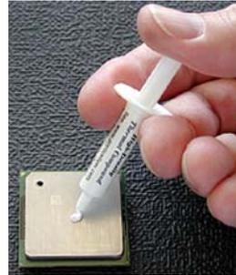
Appliquez une couche de graisse thermique Céramique Sur le processeur, et installez le waterblock sur le processeur directement.
