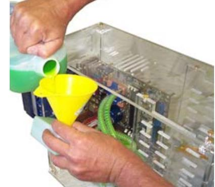
Figure 4: Il est aussi possible de remplir le réservoir à l'extérieur du boîtier, ce qui permettra la mise à niveau maximum (fig. 5). Ne pas oublier de refermer le bouchon de remplissage une fois terminé!
