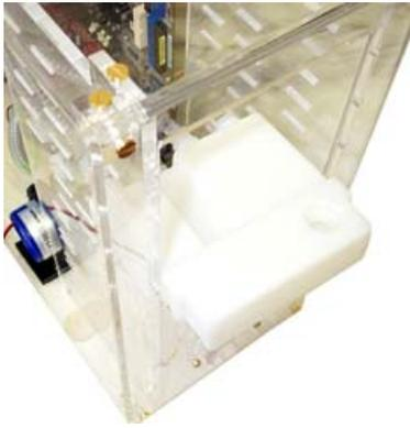
Figure 1: Toujours laisser suffisamment de mou dans les lignes afin de permettre la mise à jour de l'orifice de remplissage.
