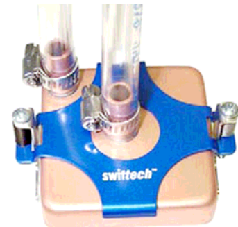
Tuyaux attachés avec les serre-tubes fournis (Plaque de fixation AMD)
