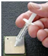
Appliquez une goutte de graisse thermique Céramique sur le processeur, et installez le water-block sur le processeur directement.
