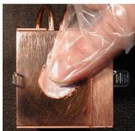
Frottez une goutte de graisse thermique Céramique sur l'embase du water-block, et nettoyez avec un chiffon propre.
