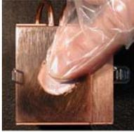
Frottez une goutte de graisse thermique Céramique sur l'embase du water-block, et nettoyez avec un chiffon propre.
